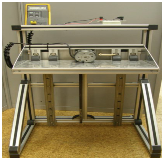
Figura 3: Plataforma elevatória acoplada a um calorímetro.
