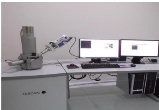
Figura 4. Microscópio Tescan Vega3 XM
