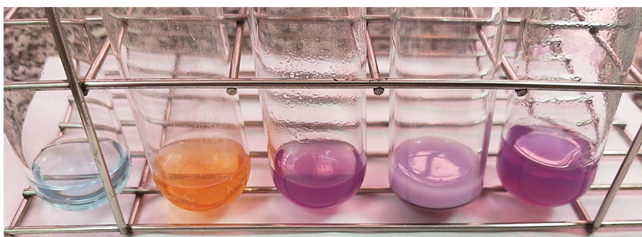
Figura 4. Análise para determinação da presença de proteínas em alimentos. Amostra 1: água+biureto; Amostra 2: água de coco+biureto; Amostra 3: proteína isolada de ervilha+biureto; Amostra 4: coalhada+biureto; Amostra 5: padrão de albumina+biureto.
