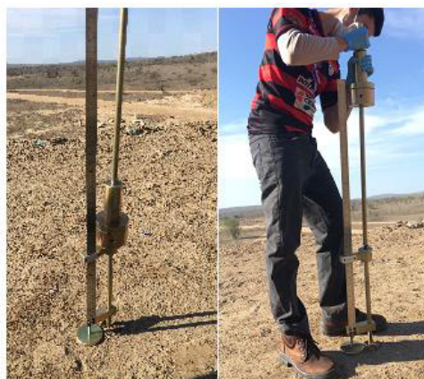
Figura 2 - Ensaio de Cone de Penetração Dinâmica (CPD)
