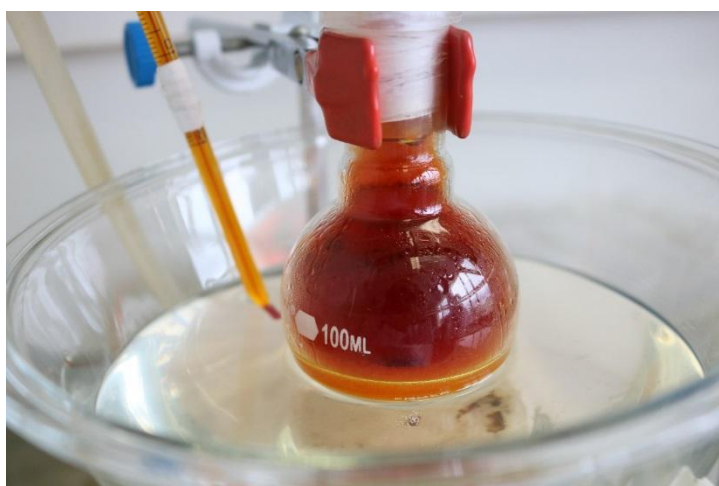
Figura 1. Detalhe do aparato para a síntese do benzil (imagem do autor).
