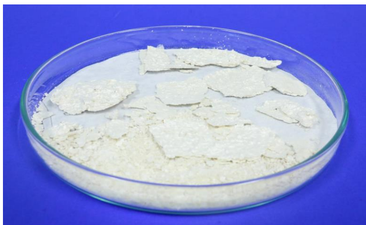
Figura 3. Fenitoína obtida sem purificação por recristalização (imagem do autor).
