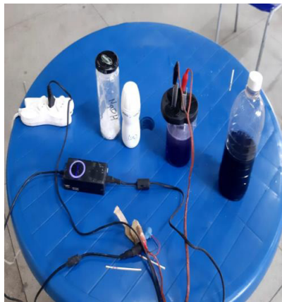
Fig. 1 - Esquema experimental da técnica de eletrofloculação.
