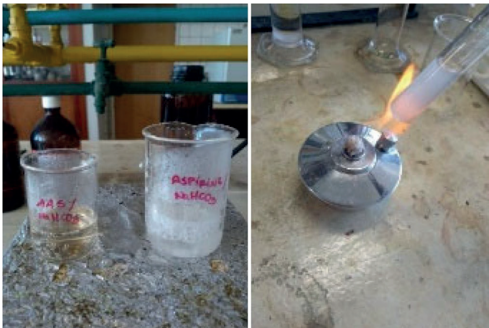
Figura 11: Reação de hidrólise alcalina do AAS. Aquecimento em placa e em lamparina a álcool.
