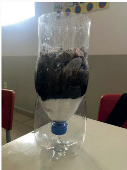
Figura 7: Filtro confeccionado com materiais de baixo custo
